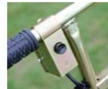
Simple bouton-poussoir (on/off) permettant un contrôle instantané de la distribution de peinture
