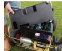
Capot amovible servant de protection et permettant un accès facile aux composants électriques
