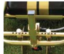
Trous d'écartement pré-perçés permettant un changement rapide de la largeur des lignes et barre de pare-chocs avant protégeant l'ensemble de la buse
